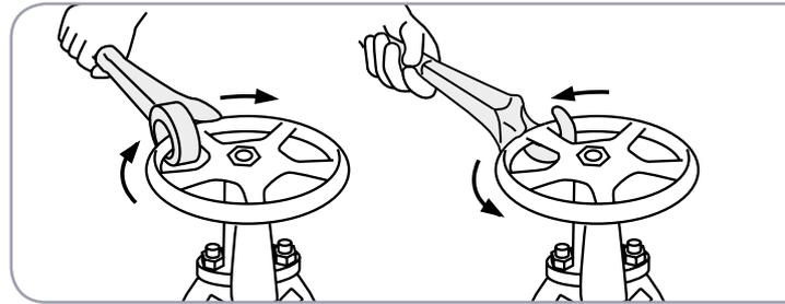
**1.** Consta de un **gancho superior** y una **mandíbula** conectados al mango. El gancho se agarra a la válvula, mientras que la mandíbula inferior se cierra contra el círculo externo de la válvula, de esta forma se logra el **agarre y manejo de la válvula**.
